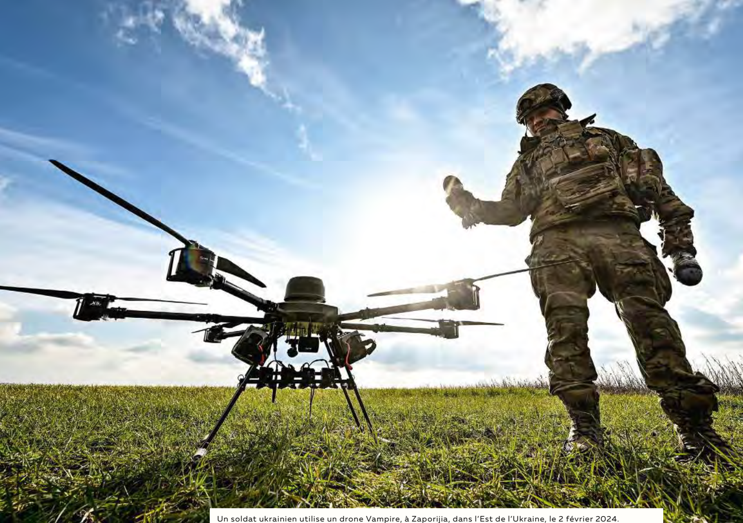
Un soldat ukrainien utilise un drone Vampire, à Zaporijia, dans l'Est de l'Ukraine, le 2 février 2024. Ce drone est équipé d'une caméra thermographique et il peut transporter une charge allant jusqu'à 15 kg.
